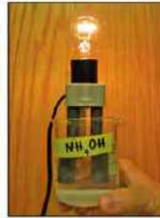
▲ شكل (١٧) القاعدة القوية توصل التيار الكهربائي بدرجة أكبر من القاعدة الضعيفة
